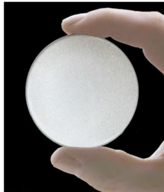
Диск из поликристаллического «дымчатого» CVD-алмаза ( \varnothing = 57 mm, толщина 0.5 mm)
