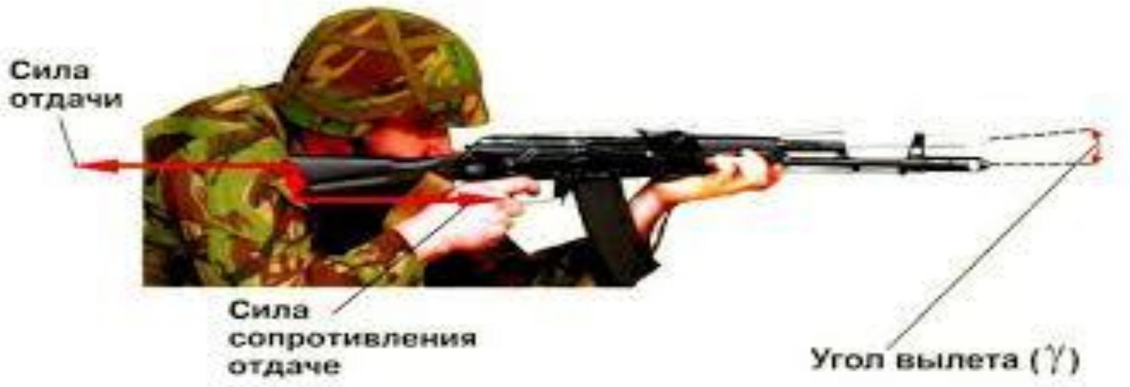
Угол, образуемый направлением оси канала ствола до выстрела и её направлением в момент вылета пули из канала ствола, называется *углом вылета*.
