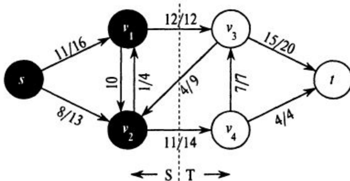
**Рис. 26.4.** Разрез  $(S, T)$  транспортной сети, представленной на рис. 26.16,  $S = \{s, v_1, v_2\}$ ,  $T = \{v_3, v_4, t\}$ . Вершины, принадлежащие  $S$ , отмечены черным цветом, а вершины  $T$  — белым
