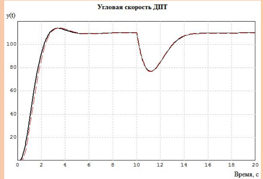
Переходные процессы: 1 – в непрерывной модели САР (рис. 33); 2 – в непрерывно-дискретной САР.
