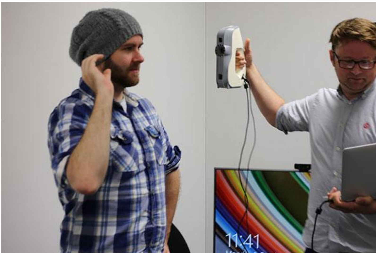
3D-сканирование человека активным сканером
