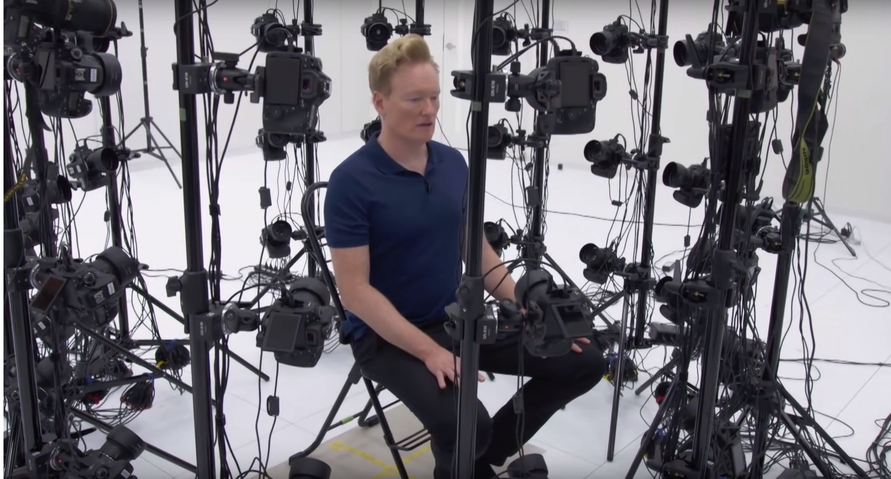
Установка для 3D-сканирования актёра в реальном времени
