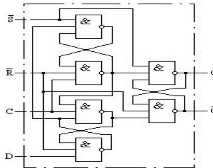
Принципиальная схема одного триггера микросхемы
