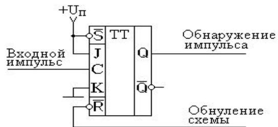
Схема обнаружения короткого импульса
