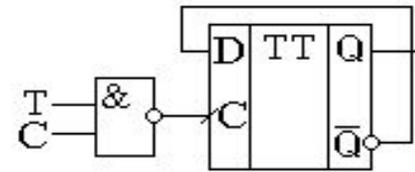
Схема синхронного T триггера, построенная на основе D триггера
