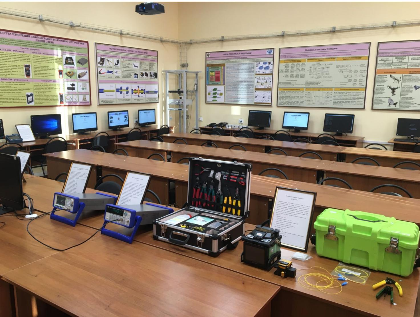
1. Локальная телекоммуникационная система на основе трех мультиплексоров Маком МХ, коммутационного, транковых шлюзов и оборудования ВОЛС и медножильных кабельных МСП.
