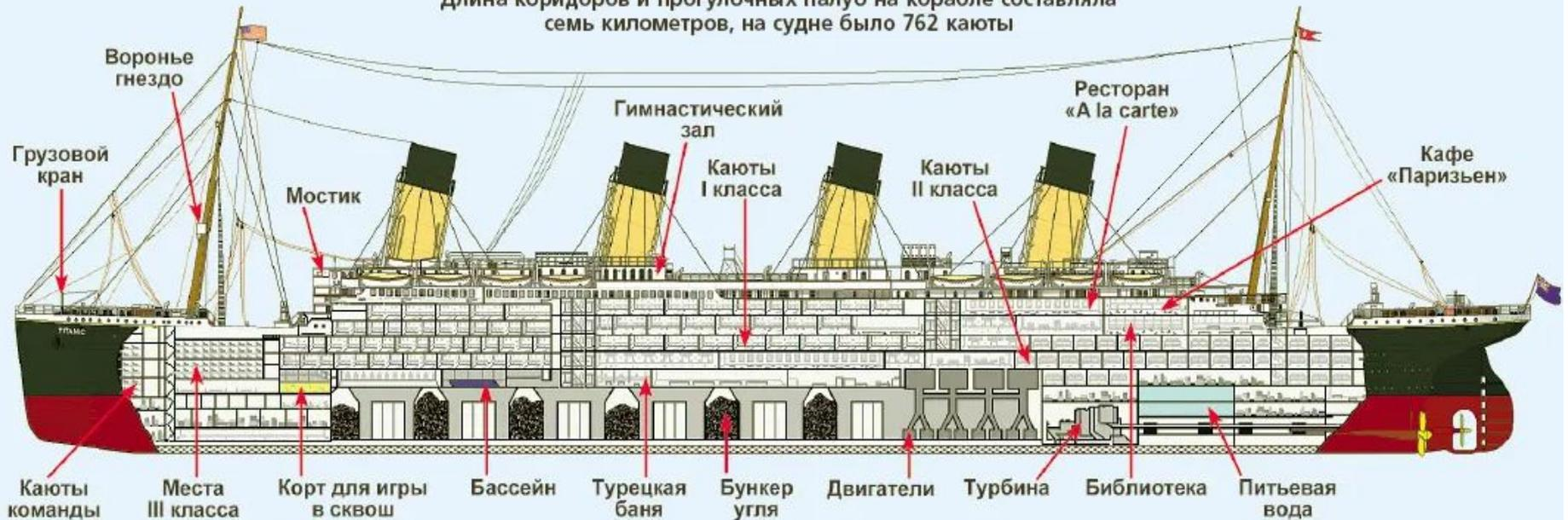
Длина «Титаника» - 270 м, ширина - 28 м. Высота от низа киля до верха труб – 53 м. Корпус полностью водонепроницаемый, был разделен на 16 отсеков. «Титаник» мог оставаться на плаву при затоплении 4 отсеков.
