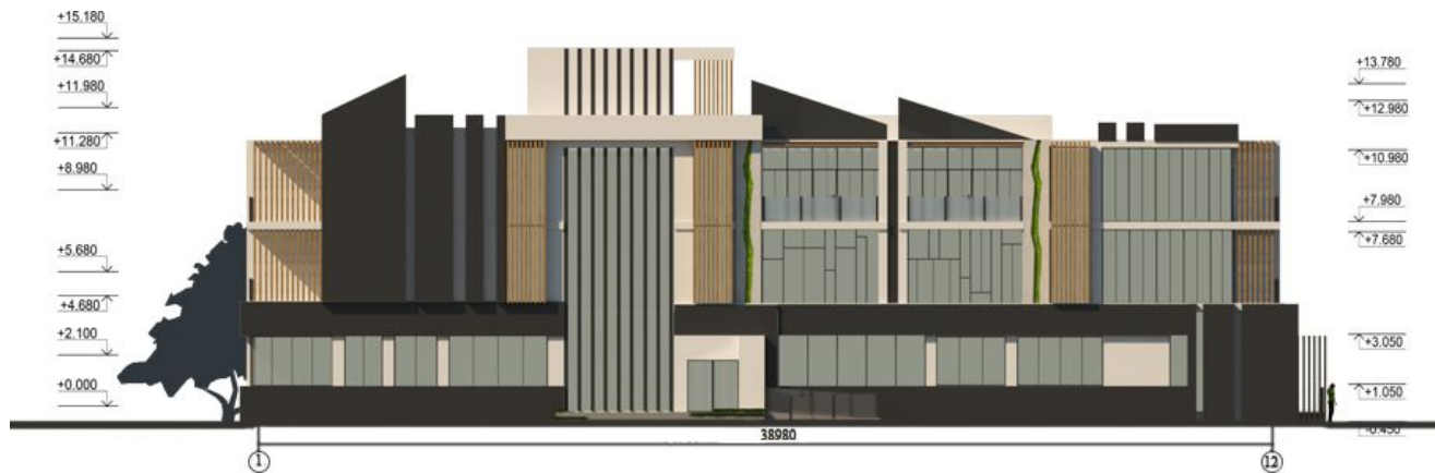
Фасад в осях 1-12
