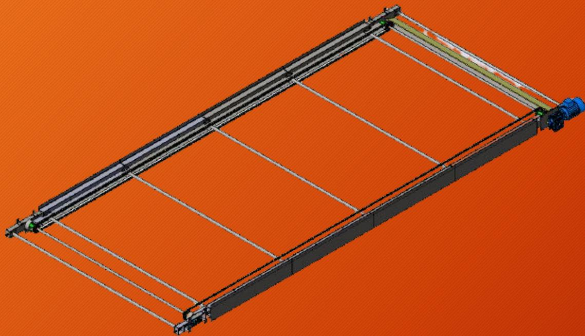
Скребокый механизм предназначен для удаления поверхностных загрязнений.
