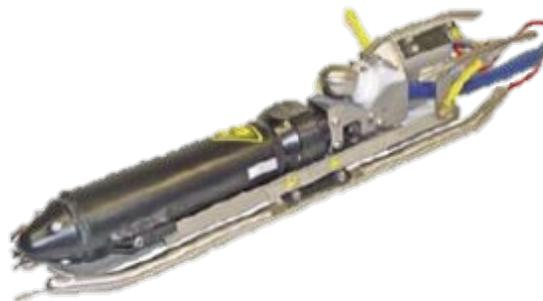
Инспекция трубопроводов осуществляется цветной телекамерой с высокой разрешающей способностью и цифровым увеличением изображения, что позволяет получить детализированную информацию о техническом состоянии сети. Телекамера способна обнаружить даже небольшие трещины и течи, засоры и посторонние предметы, определить точное местоположение и характер дефекта, состояние трубопровода вокруг дефекта. Видеосъемка может производиться круглосуточно и независимо от погодных условий.
