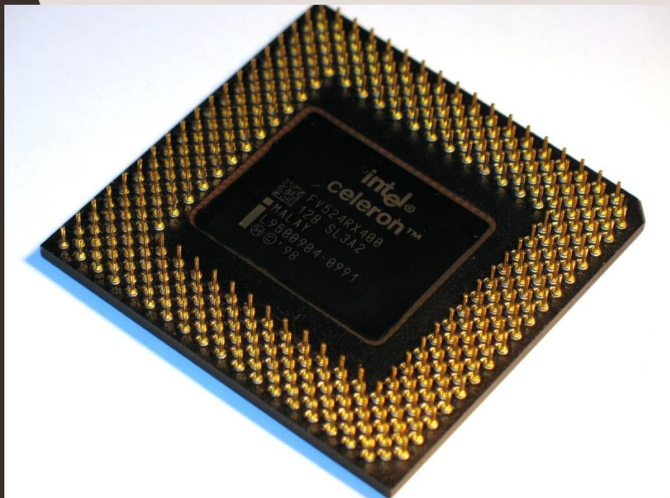
Кристалл-пластинка обычно помещается в пластмассовый или керамический плоский корпус металлическими штырьками, чтобы его можно было присоединить к системной плате компьютера.
