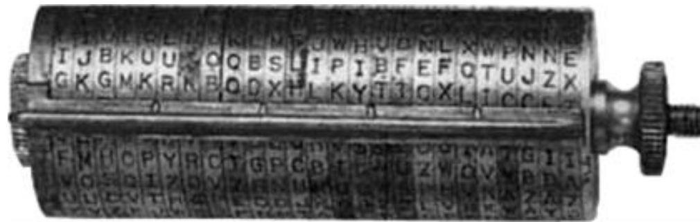
Шифратор Джефферсона (начало XIX века)
