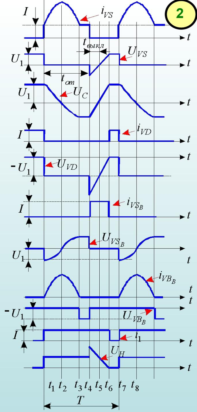
**Интервал**  $\Delta t_2 = t_4 - t_3$  . Изменяя  $\Delta t_2$  между отпиранием тиристоров  $VS$  и  $VS_B$  можно воздействовать на время  $t_{om}$  проводящего состояния тиристора  $VS$  :
