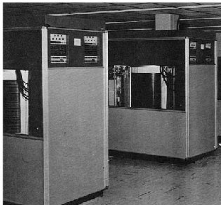
Два жёстких диска (disk files) машины IBM 305
