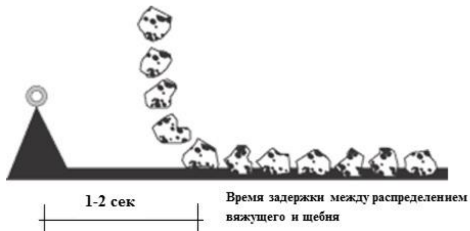
Поверхностная обработка с синхронным распределением материалов
