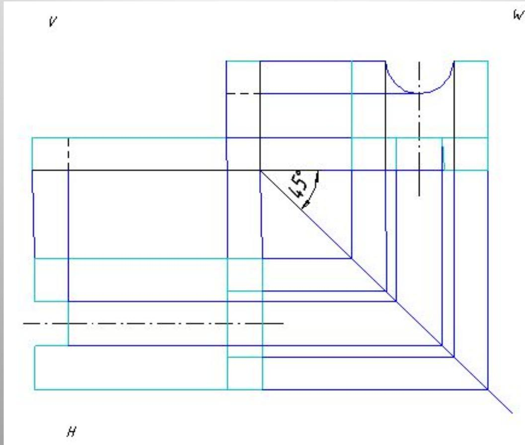
Использование постоянной прямой позволяет не строить оси координат и за счёт этого уменьшить расстояние между видами.
