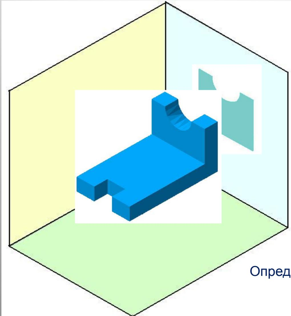
Определяет ширину и высоту.
