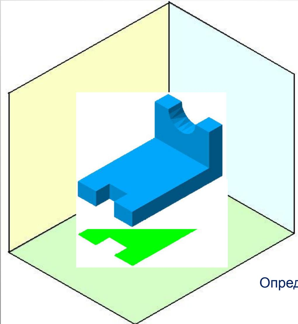
Определяет длину и ширину.
