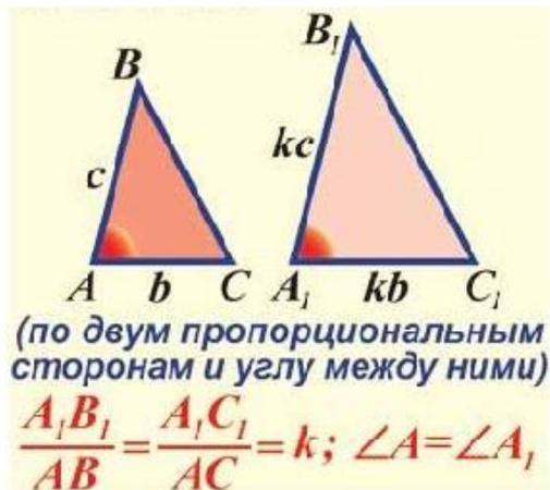
**II. Если две стороны одного треугольника пропорциональны двум сторонам другого треугольника и углы, заключенные между этими сторонами, равны, то такие треугольники подобны.**
