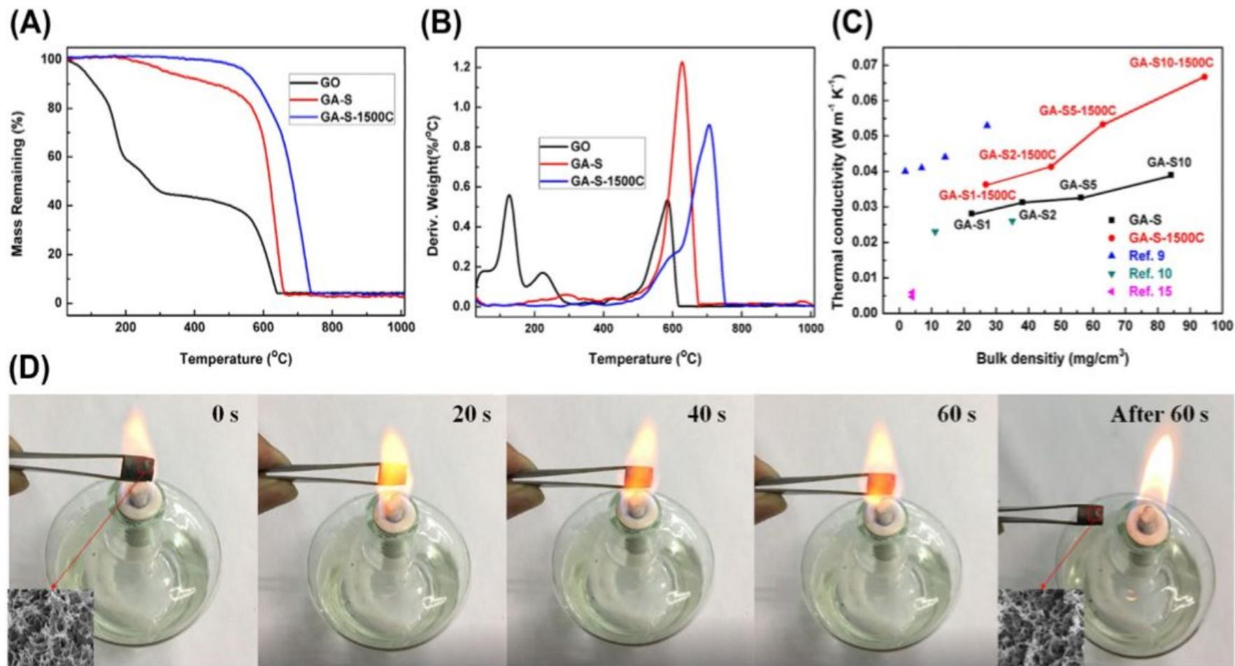
Термогравиметрические (A) и разностные термогравиметрические (B) графики содержания оксида графена (GO), аэрозоля GN (GA) -S и GA-S-1500C в воздухе. (C) Теплопроводность GA-S, GA-S-1500C и других низкотеплопроводных графеновых аэрогелей. (D) Снимки образца GA-S-1500C в горячем пламени спиртовой горелки, вставки в (d) представляют собой микроструктуру испытуемого образца.
