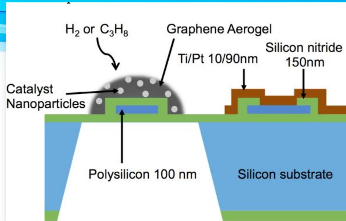
Датчик горючего газа на основе микронагревателя малой мощности с поддержкой катализатора из аэрогеля графена
