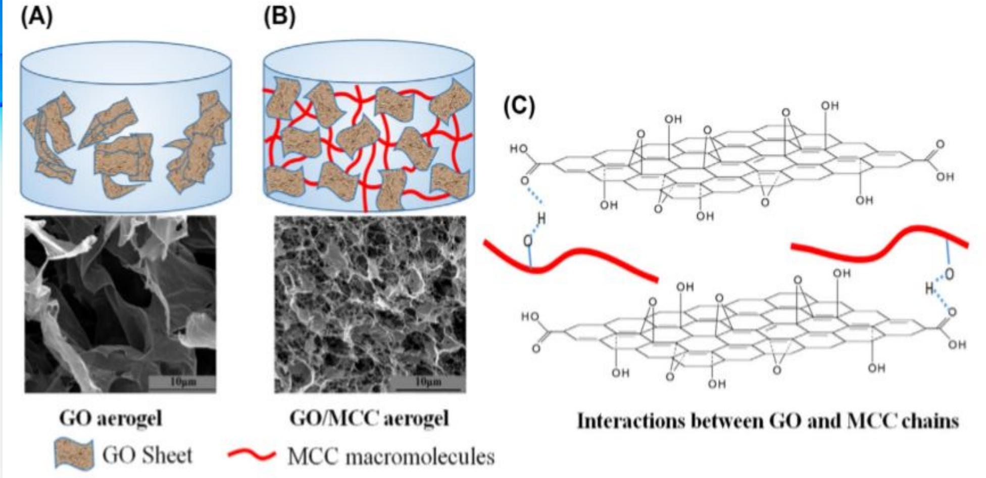
*Схематические изображения, показывающие микроструктуру (A) аэрогеля из чистого оксида графена (GO) и (B) аэрогеля из GO/микросталлической целлюлозы (MCC), и (C) взаимодействия между цепями GO и MCC.*
