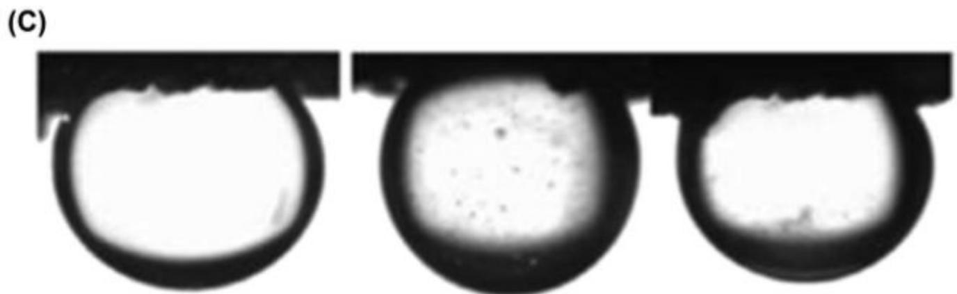
Процесс поглощения капли (А) воды и (В) дизельного топлива поверхностью аэрогеля из композитного графена; (С) оптические изображения капли дизеля на поверхности композитного аэрогеля в водных растворах  $\text{NaOH}$ ,  $\text{HCl}$  и  $\text{H}_2\text{O}$ .
