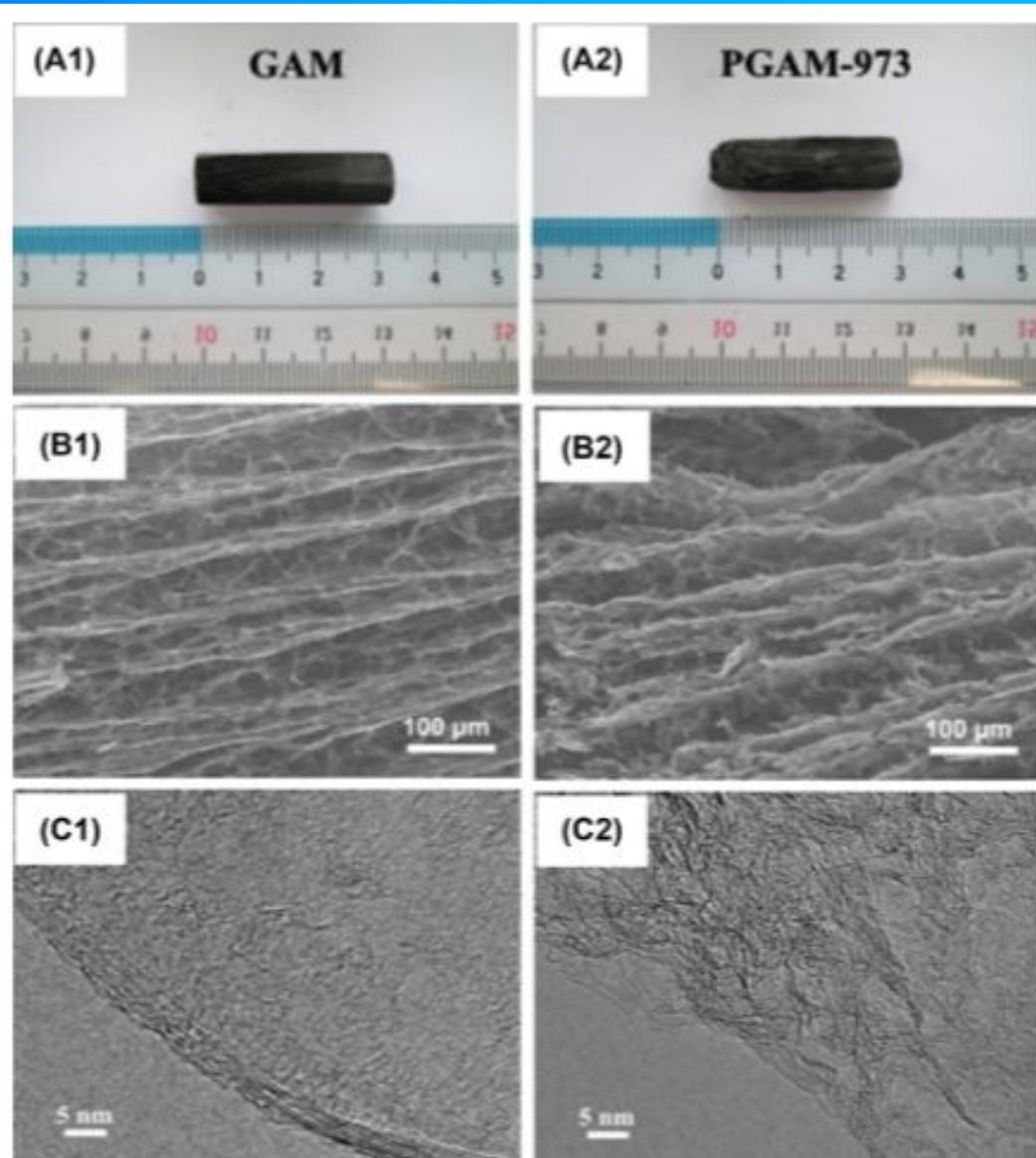
Морфология графенового аэрогельного монолита до и после активации сохранения формы. (А) фотографии, (В) изображения сканирующей электронной микроскопии (SEM) и (С) изображения просвечивающей электронной микроскопии (TEM) монолитного графенового аэрогеля.
