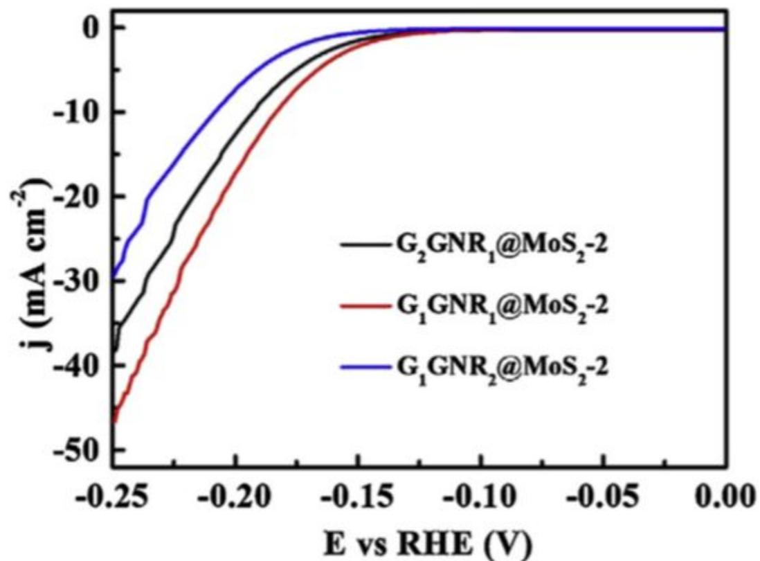
Поляризационные кривые линейной развертки вольтамперометрии (LSV) для  $G_2GNR_1@MoS_2-2$ ,  $G_1GNR_1@MoS_2-2$  и  $G_1GNR_2@MoS_2-2$  модифицированного стеклоуглеродного электрода (GCE) в очищенном от N<sub>2</sub> 0,5 M растворе H<sub>2</sub>SO<sub>4</sub>. Скорость сканирования: 2 мВ с
