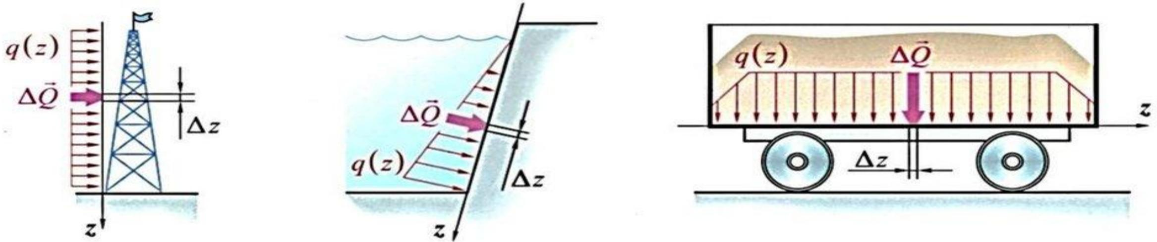
Распределенные нагрузки задаются интенсивностью. При плоской нагрузке:
