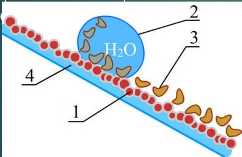
Процесс лотос-эффекта: 1 – нанопокрытие; 2 – капля жидкости (воды); 3 – загрязнение; 4 – поверхность (стекло, краска, керамика и т.д.)
