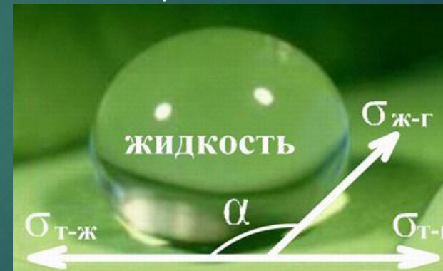
Капля жидкости на супергидрофобной поверхности (капля касается листа только в нескольких точках, стягивается за счет поверхностного натяжения к шару и при самых незначительных углах наклона свободно скатывается)
