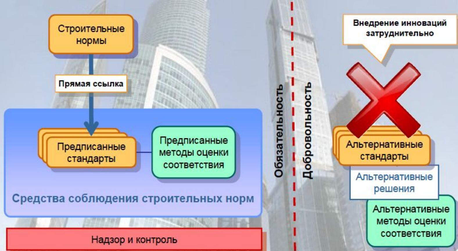
Схема исполнения строительных норм
