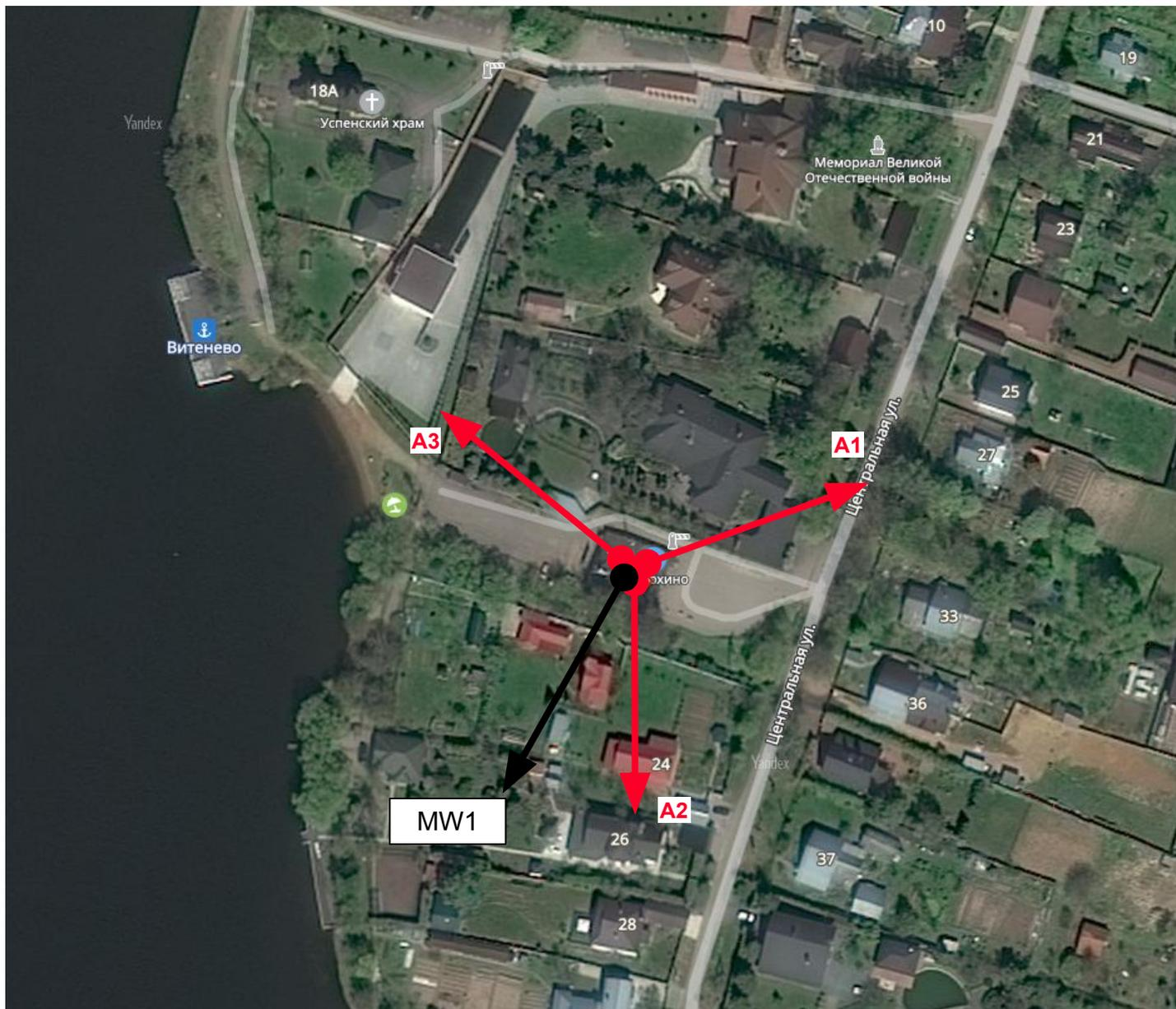
Исполнитель: Дозорцев В.Е. Рис.2. Ориентиры азимутов установки антенн GSM/DCS
