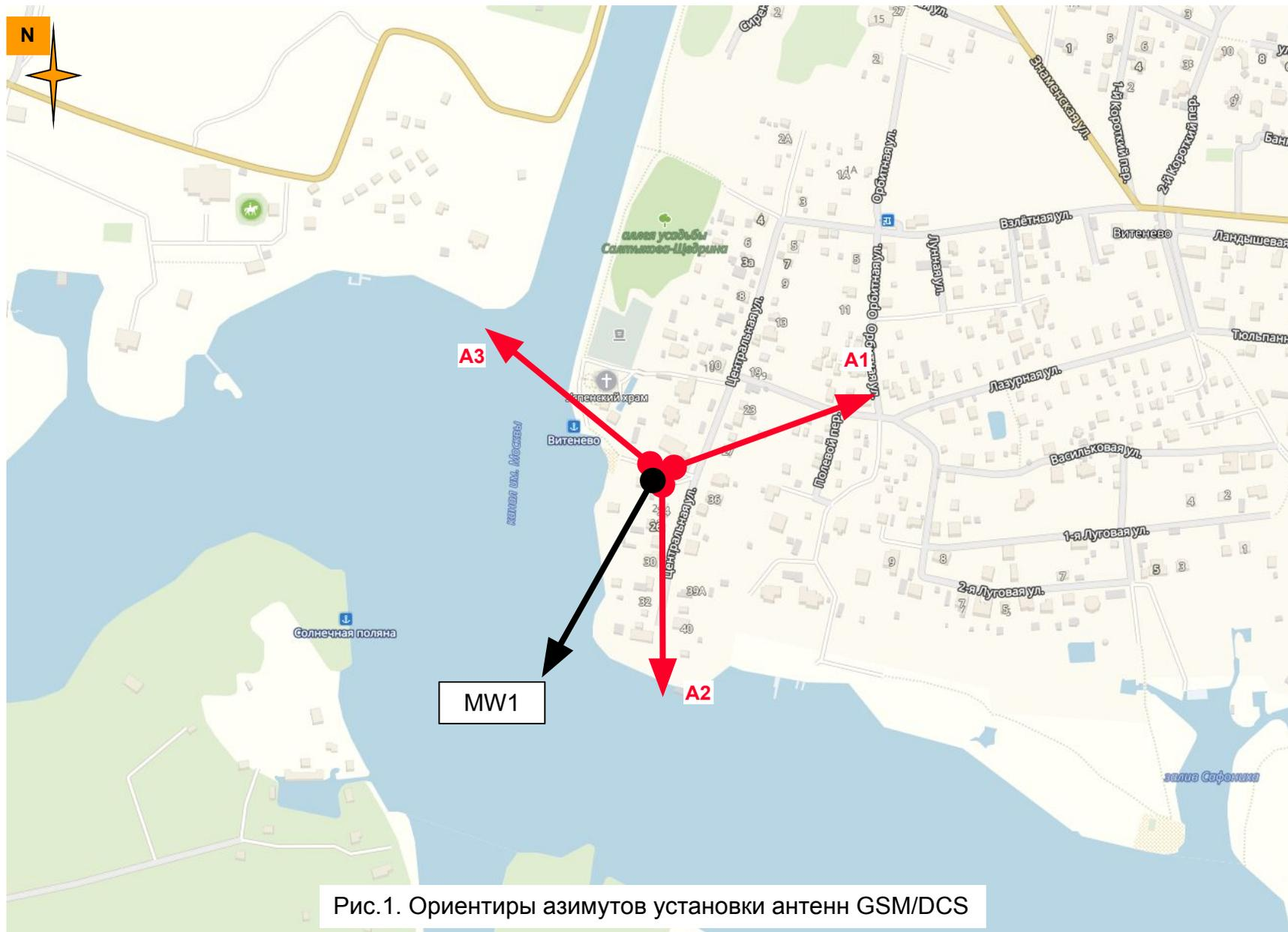
Рис.1. Ориентиры азимутов установки антенн GSM/DCS
