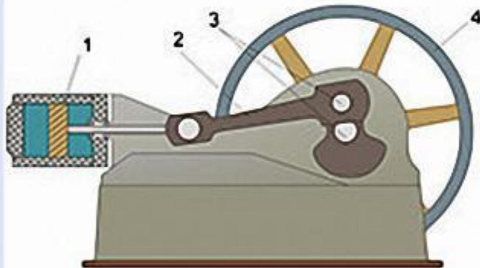
Схема паровой машины: 1 — поршень; 2 — шатун; 3 — коленчатый вал; 4 — маховик.
