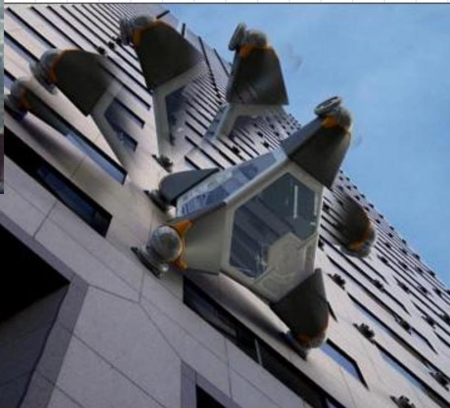
Аппарату предназначено взбираться по вертикальным поверхностям — например, по стенам многоэтажных зданий. Только по специально подготовленному — с размещёнными в нужных местах креплениями типа альпинистских. Именно за них цепляется Delto своими вершинами, вперевалку перебираясь всё выше и выше.
