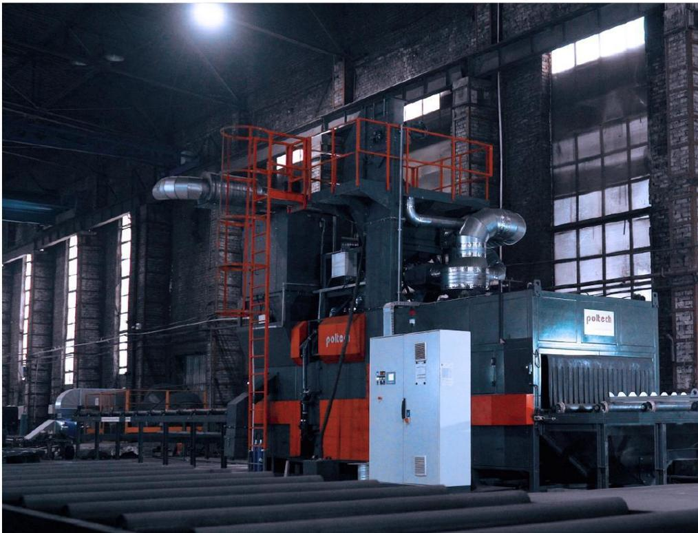
Автоматическая дробеструйная камера
