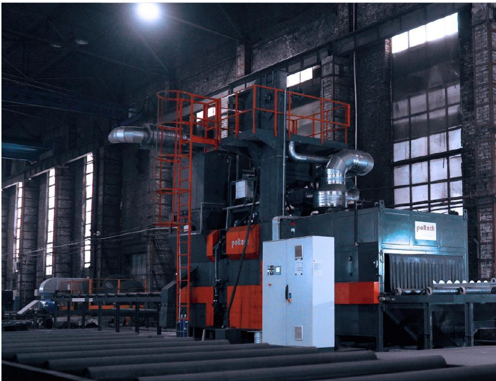
Автоматическая дробеструйная камера
