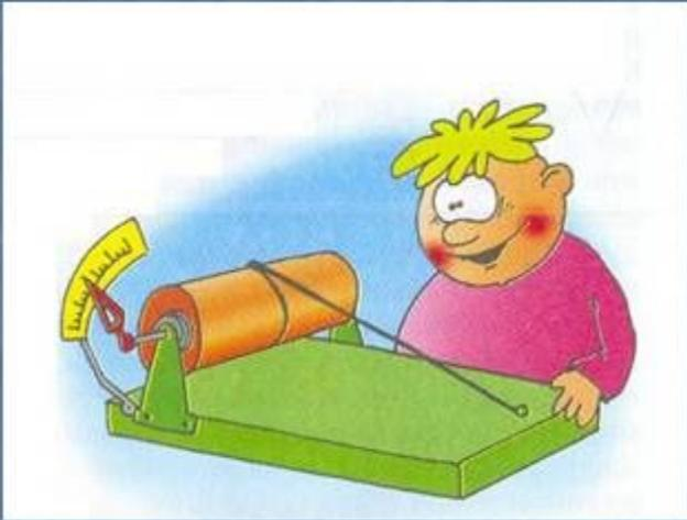
**Действие волосного гигрометра Основано на свойстве обезжиренного человеческого волоса удлиняться при увеличении относительной влажности воздуха.**
