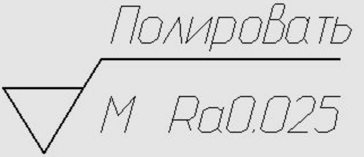
Вид обработки поверхности указывают в обозначении шероховатости только в случаях, когда он является единственным, применимым для получения требуемого качества поверхности.
