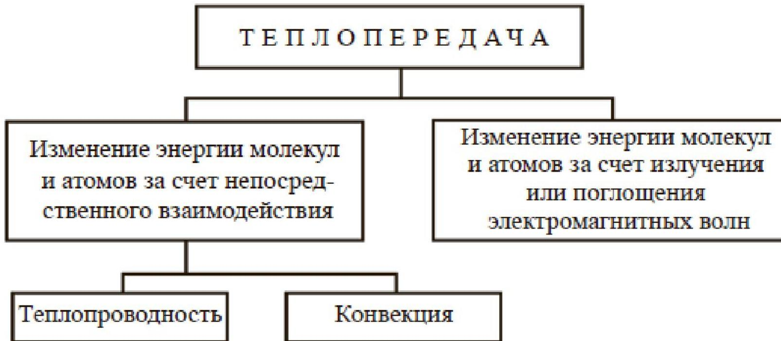
**Конвективный теплообмен (К)** – возникает между воздухом в помещении и поверхностями ограждений и приборов.
