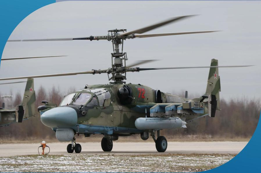
**Подъемная сила вертолета создается при помощи несущего винта. Различают вертолеты одновинтовые с рулевым (хвостовым) винтом; двух- или многовинтовые. Несущие винты приводятся в действие одним или несколькими моторами. Скорость полета вертолета составляет до 350 км/час. Грузоподъемность - до 40 тонн.**
