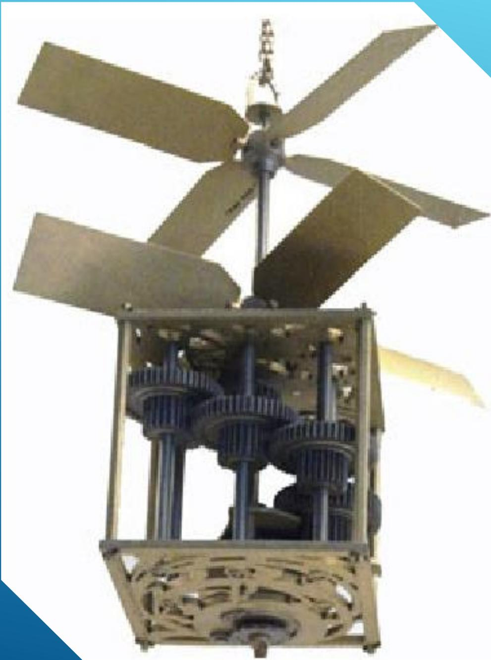
**В 1754 году великий русский ученый и естествоиспытатель М.В. Ломоносов изобрел и построил «аэродинамическую машинку», представляющую собой модель вертолета, поднимающегося в воздух с помощью двух винтов. Винты приводились в действие пружиной, наподобие часового механизма. В отчете он записал, что цель этой работы – создать машинку, которая поднимаясь сама, могла бы поднять и маленький термометр для измерения температуры на высоте.**
