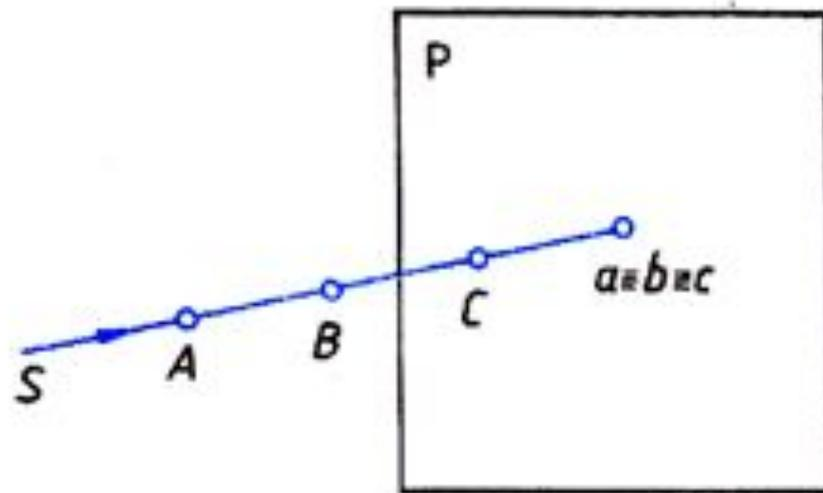
Проецирование нескольких точек:  $A$ ,  $B$ ,  $C$ , лежащих на одном луче ( проекции точек –  $a$ ,  $b$ ,  $c$ ).
