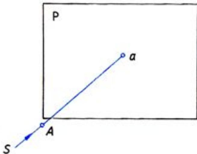
Проецирование точки  $A$  (проекция точки на плоскость –  $a$ ).
