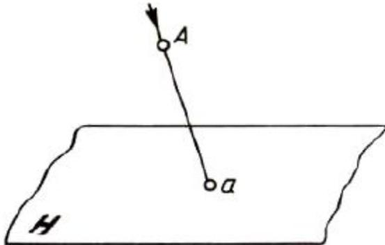
Плоскость  $H$ , на которой получается проекция, называется плоскостью проекций.
