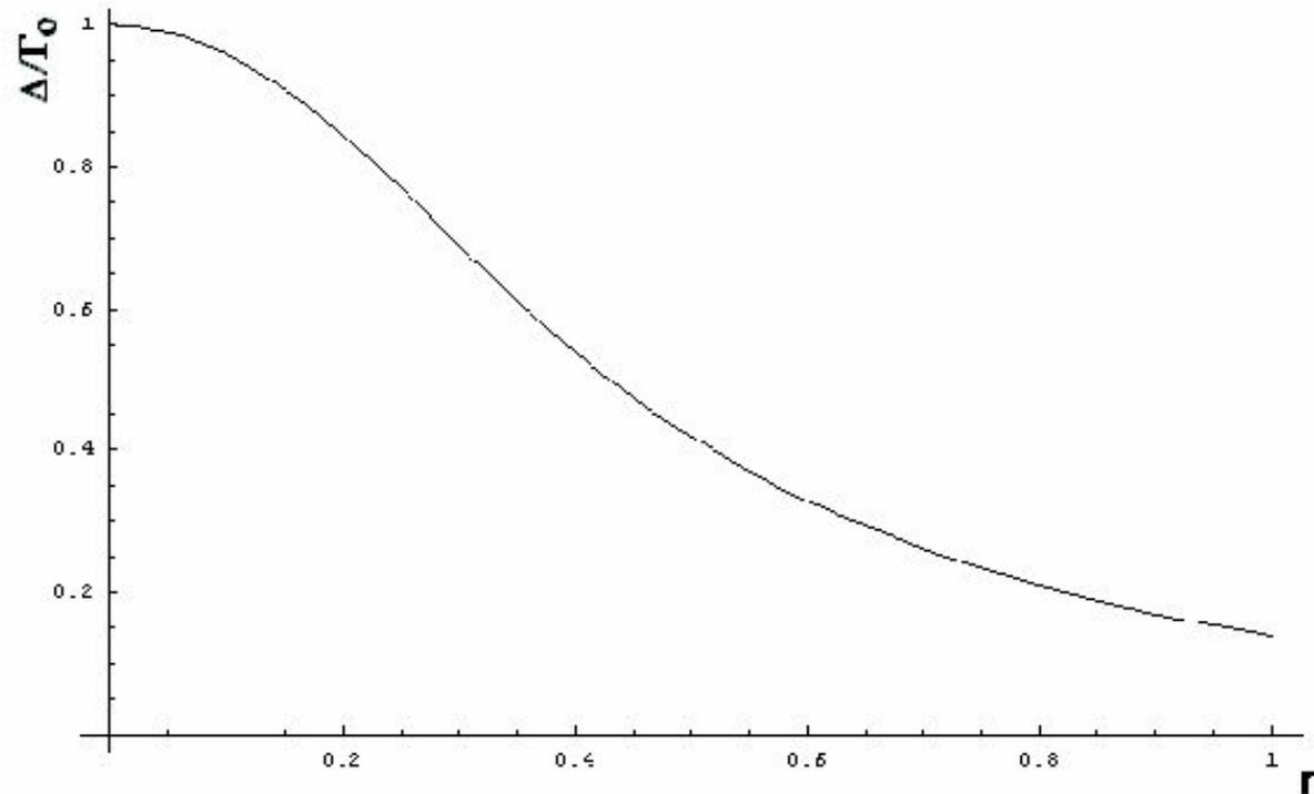
Рис. 4.2: Отношение ширины линии  $\Delta$  двухуровневого атома при релаксации в "сжатом" термостате к ширине линии в обычном термостате  $\Gamma_0$  в зависимости от параметра сжатия  $r$ .
