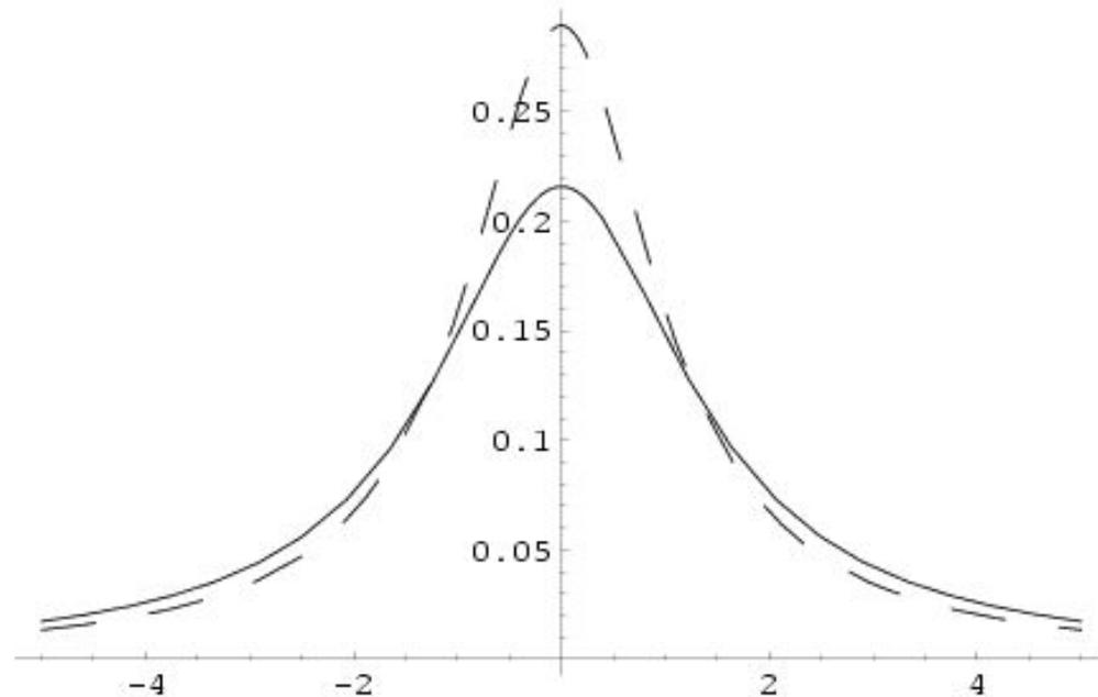
Рис. 4.3: Контур линии излучения спонтанной релаксации трехуровневого V- атома на переходе  $1 \leftrightarrow 2$ .  $\gamma_1/(\frac{\omega_0}{2} + \Omega_0) = 0.1$ ,  $\gamma_3/(\frac{\omega_0}{2} + \Omega_0) = 0.5$ ,  $\mathcal{N}_1 = 1$ ,  $\mathcal{N}_3 = 1.5$ . Пунктирной линии соответствует контур линии двухуровневого атома при тех же условиях.
