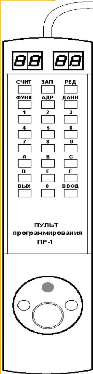
Пульт программирования ПР-1 предназначен для программирования конфигурации энергонезависимой памяти приборов «Аб» (всех исполнений).
