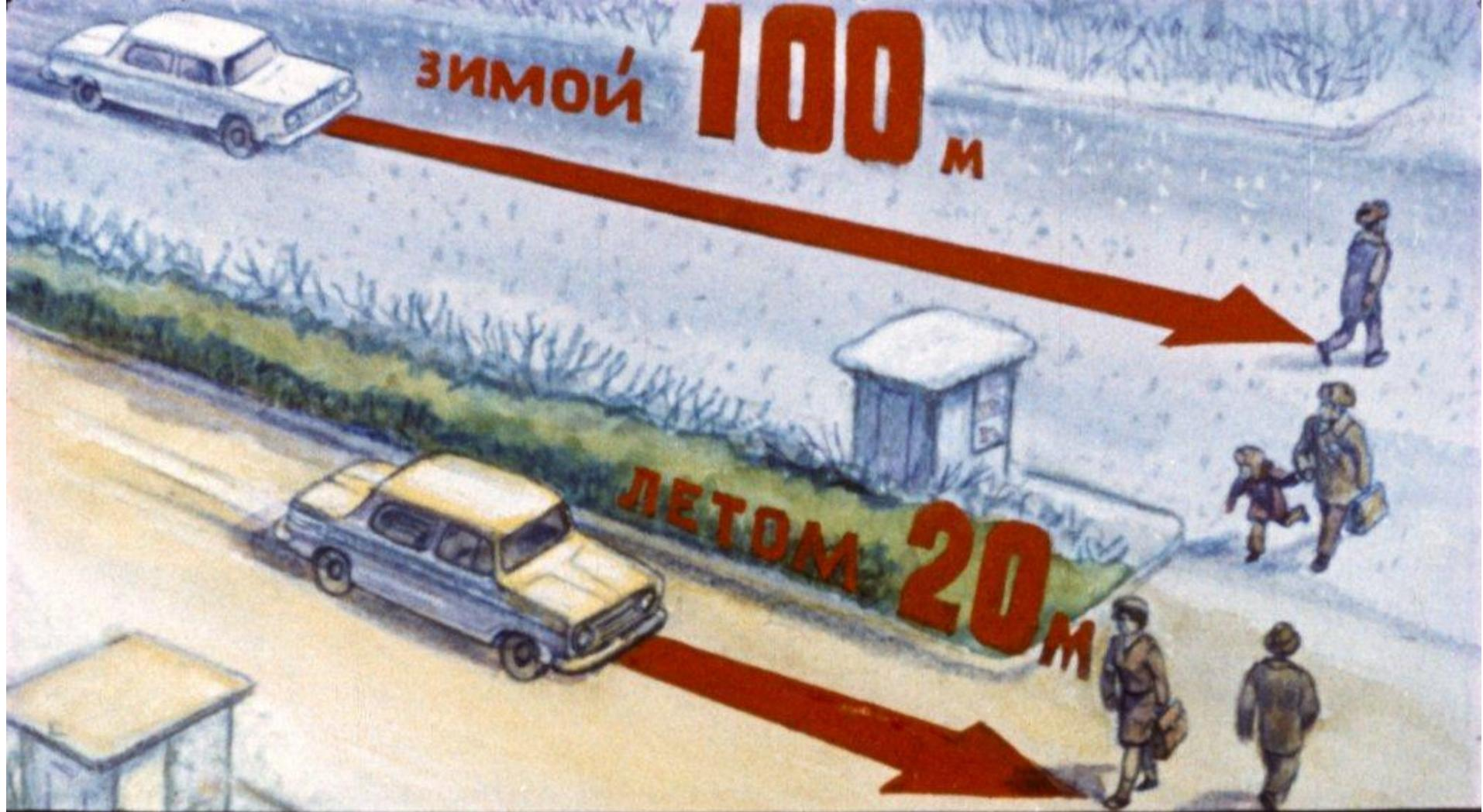
На зимней дороге значительно увеличивается путь торможения автомобиля. Если на сухой дороге летом при скорости 60 километров в час машине для остановки нужно 20 метров, то на льду это расстояние превышает 100 метров.
