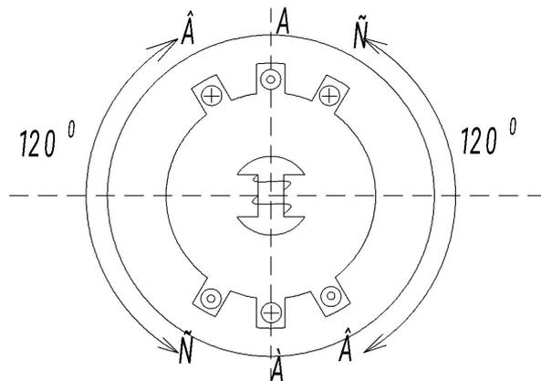
Такую систему ЭДС получают с помощью одного 3-х фазного генератора. Конструктивно простейший 3-х фазный генератор имеет вид
