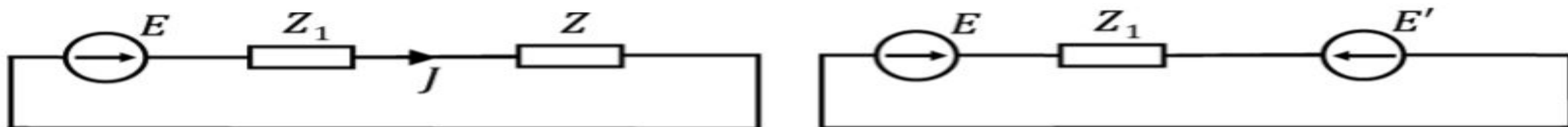
Рисунок 7. Пример электрической цепи до (а) и после (б) применения теоремы компенсации.
