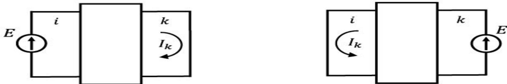
Рисунок 6. Источник ЭДС находится в  $i$ -ом (а) и  $k$ -ом (б) контуре.
