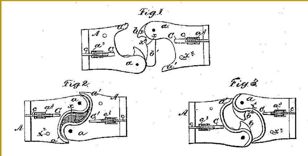
В 1887 году МСВ (Master Car Builders Association) существенно модернизировала сцепное устройство — изменила контур зацепления. В дальнейшем контур зацепления изменялся на автосцепке, с сохранением совместимости, в 1904, 1916 (принят тип «D»), 1918, 1930 (принят тип «E»)
