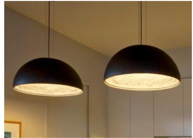
Потолочные висячие светильники (люстры) (рис. 10, а) применяют для создания общего освещения, особенно в помещениях с высокими потолками. Свет таких светильников объединяет пространство. Висячие светильники часто устанавливают над обеденным столом, выделяя этот фрагмент интерьера и создавая уют.
