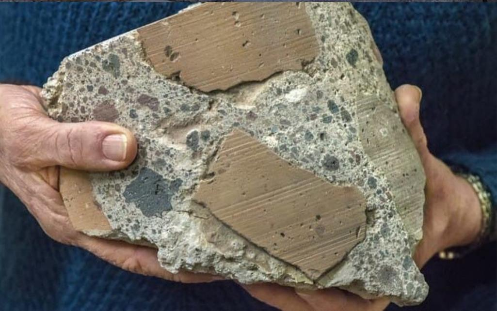
Заливая бетоном пространство между двумя стенками, выложенными из кирпича, зодчие добивались невероятной устойчивости конструкции, и тем самым могли строить многоэтажные здания. Снаружи их покрывали гранитом или мрамором, богато украшали скульптурным декором.
