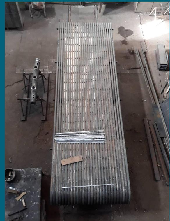
**Газоплотные и мембранные поверхности нагрева.**
