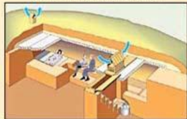
Быстровозводимое противорадиационное укрытие из железобетонных плит
