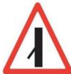
2.3.7 Примыкание второстепенной дороги
