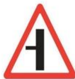
2.3.3 Примыкание второстепенной дороги
