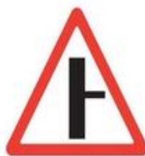
2.3.2 Примыкание второстепенной дороги
