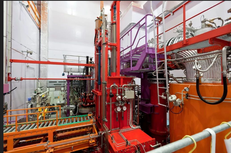
Плазменная печь для сжигания радиоактивных отходов
