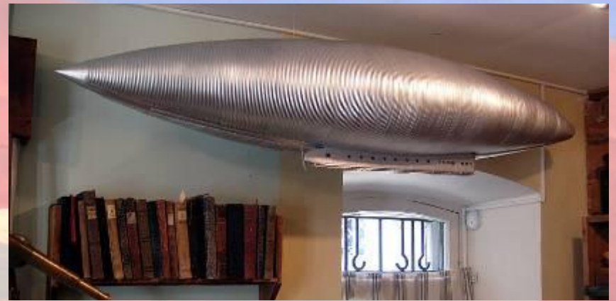
Модель оболочки аэростата из гофрированного металла
