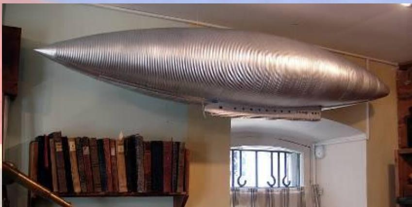
Модель оболочки аэростата из гофрированного металла
