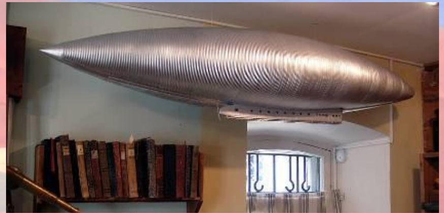
Модель оболочки аэростата из гофрированного металла
