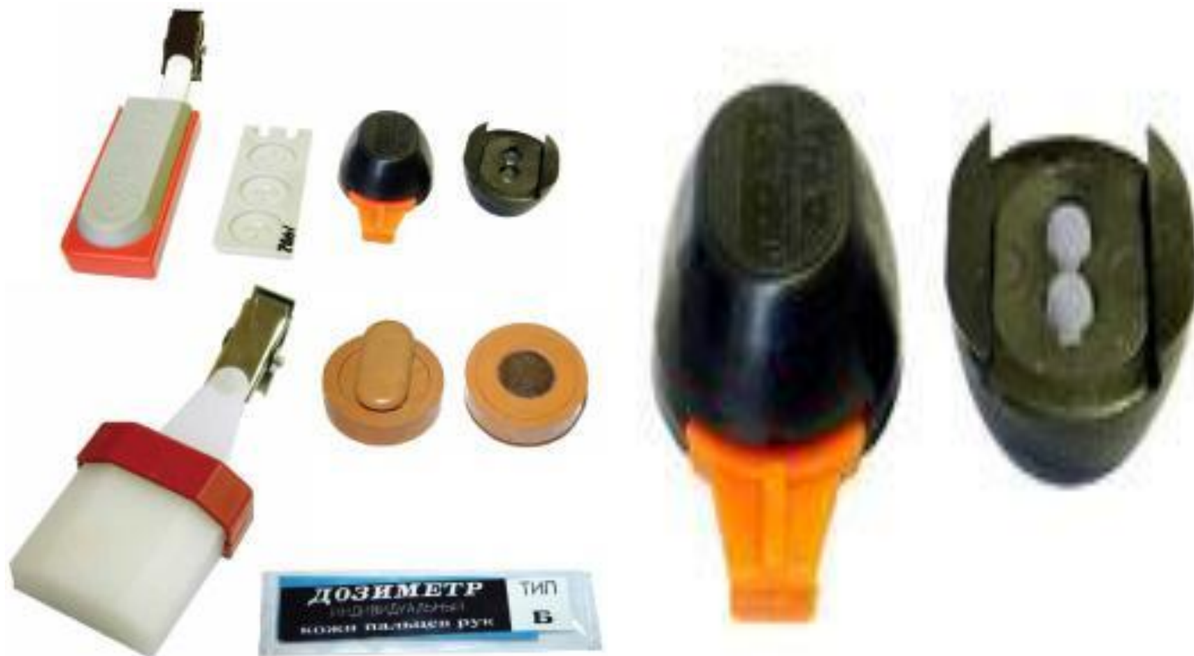
Рис.3. Различные типы ТЛ-дозиметров
