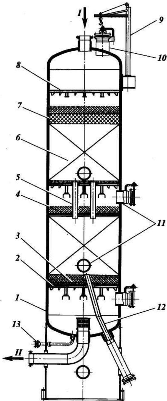
**Рис.2.** Адсорбер аксиального типа с неподвижным слоем адсорбента
