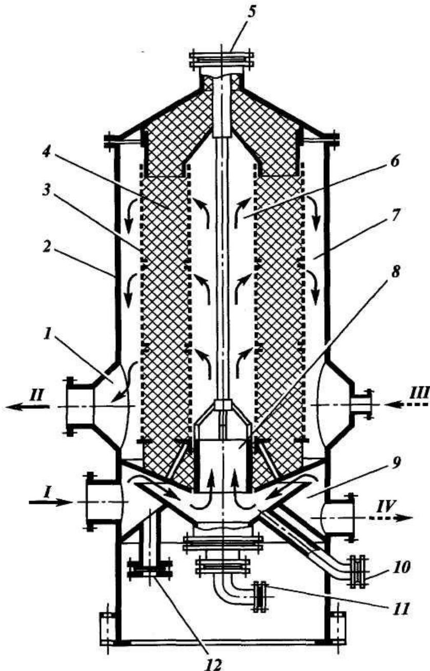
**Рис.3.** Адсорбер радиального типа с неподвижным слоем адсорбента
