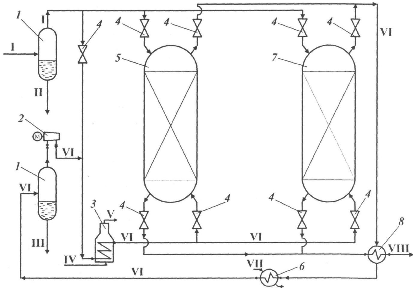
**Рис. 2А. Технологическая схема адсорбционной установки осушки газа**
