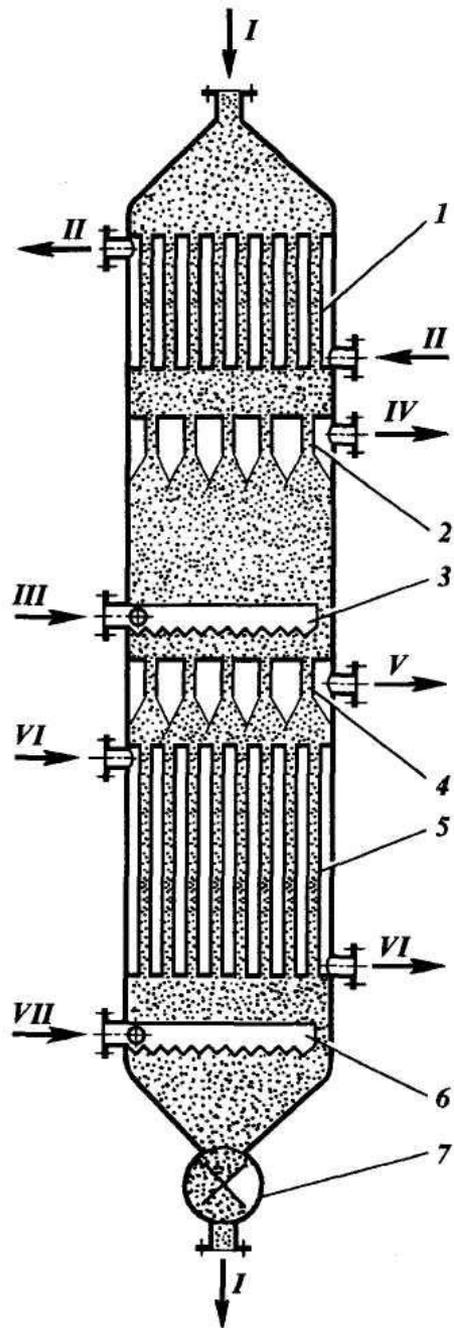
**Рис.4.** Адсорбер с движущимся зернистым слоем адсорбента
