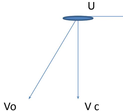
Для решения задачи строим треугольник, перенеся вектор скорости  $V_0$  и для определения  $V_0$  используем теорему Пифагора (квадрат Гипотенузы равен сумме квадратов Катетов)
