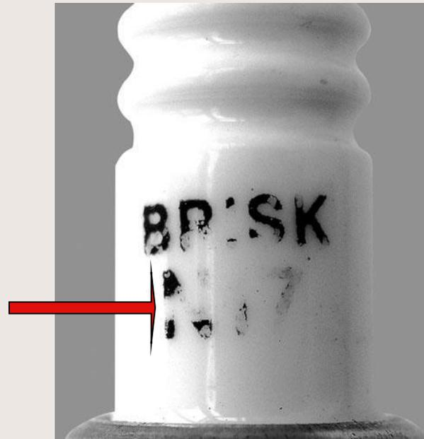
**Логотип на изоляторе возможно у подделки стереть, потому что логотип на подделке в отличие от оригинала – нанесен на поверхности изолятора.**
