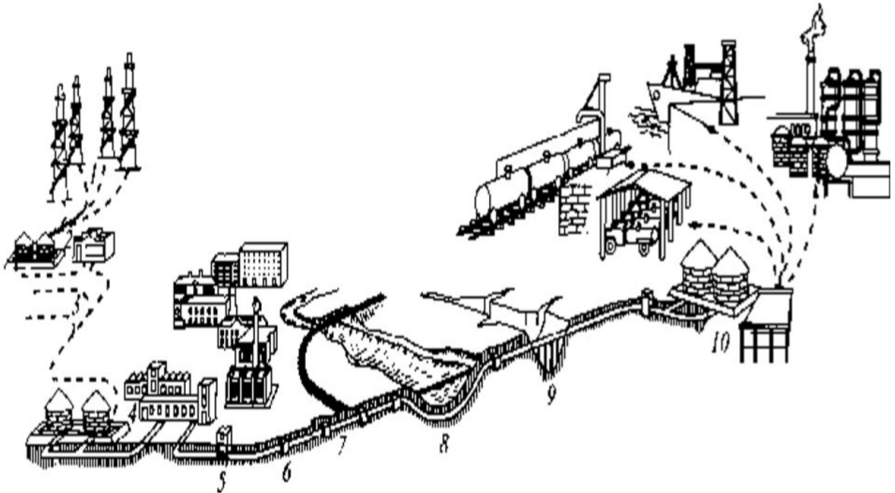
Промежуточные насосные станции (ПНС) принимают и направляют нефть и нефтепродукты далее по трубопроводу до следующей станции, к конечным и промежуточным распределительным пунктам.
