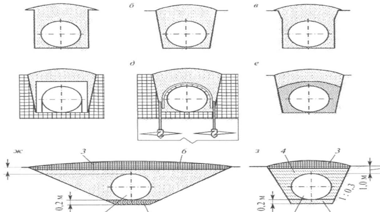
ж – укладка в зонах активных тектонических разломов; з – укладка с песчаной подсыпкой вне зон разломов; 1 – трубопровод; 2 – минимальное заглубление; 3 – засыпка почвеннорастительным грунтом; 4 – грунт из отвала; 5 – подсыпка песком; 6 – засыпка крупнозернистым песком; 7 – подсыпка крупнозернистым песком
