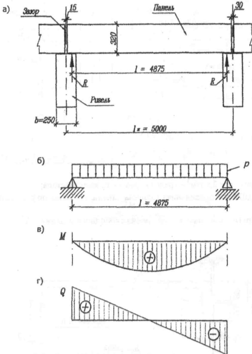
Рис. 12. К расчёту продольного ребра панели:
