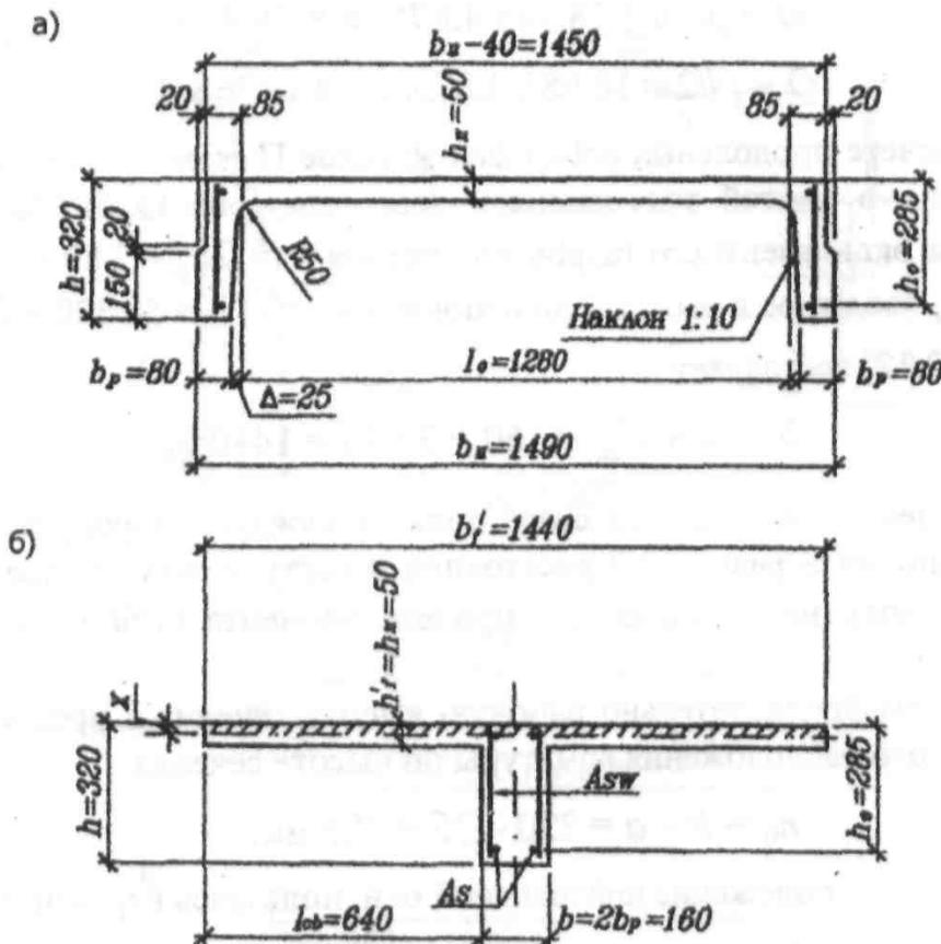
Рис. 13. Приведение сечения панели к эквивалентному:
