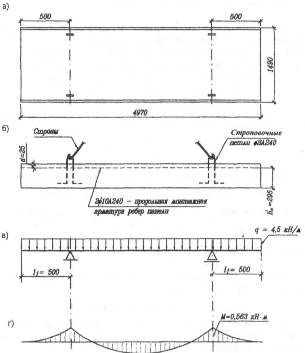
Рис. 16. К расчёту прочности сборной панели перекрытия на нагрузки, возникающие во время транспортирования и монтажа:
