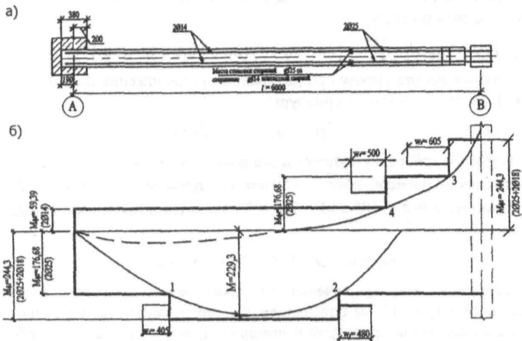
Масштабы размеров 1:20; изгибающих моментов – 1 см соответствует 40 кН·м; поперечных сил – 1 см соответствует 40 кН
