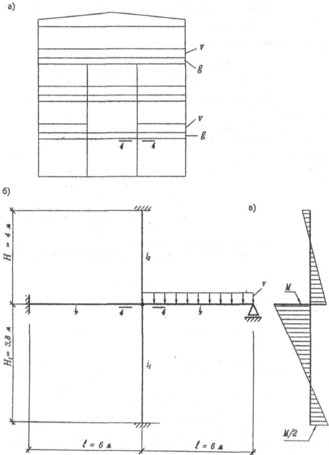
Рис. 20. К определению изгибающего момента в сечении колонны 4-4:
