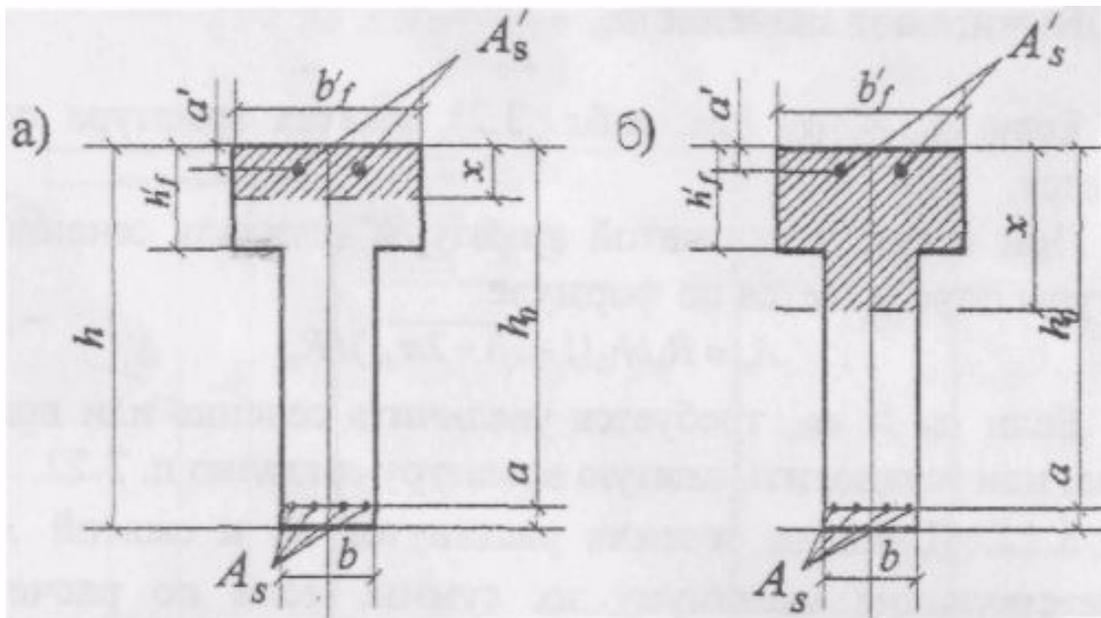
Значение  $b'_f$ , вводимое в расчет, принимают из условия, что ширина свеса полки в каждую сторону от ребра должна быть не более  $1/6$  пролета элемента и не более:
